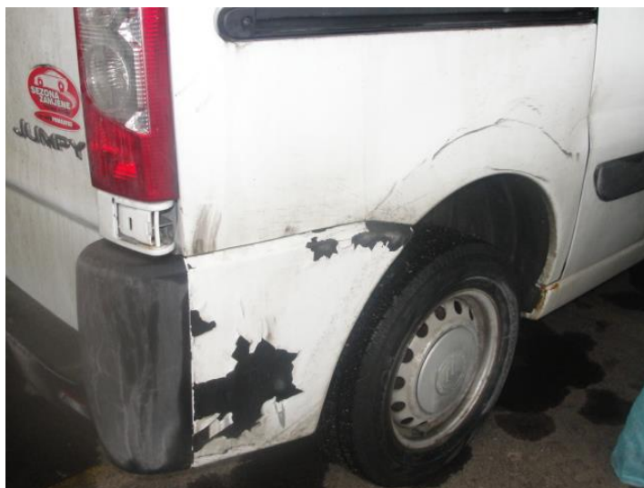
Slika broj 1.5.- oštećenja na limariji otraga desno
